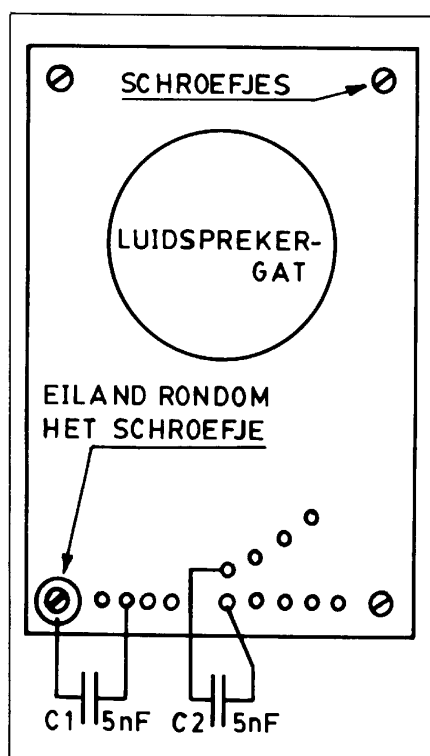
Fig. 1. Ter voorkoming van HF instraling moeten op de print X54-1480-10 (achter de luidspreker gemonteerd) twee keramische condensatoren worden aangebracht: C1 = C2 = 5 \text{ nF} .
